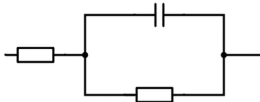
Slika 7. Samopražnjenje kondenzatora preko paralelno spojenog otpornika.
