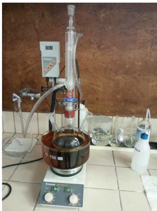
Slika 3.3. Aparatura u kojoj provedena redukcija grafena
