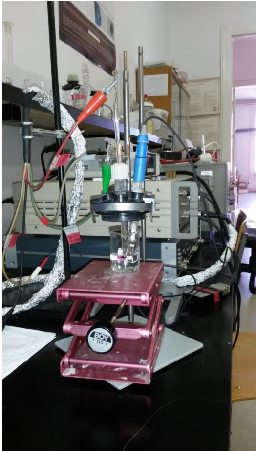
Slika 3.5. Aparatura za elektrokemijska ispitivanja
