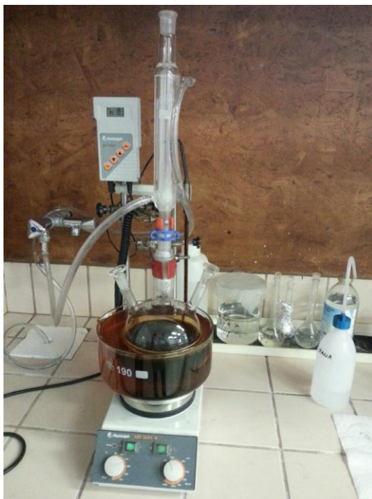
Slika 3.3. Aparatura u kojoj provedena redukcija grafena
