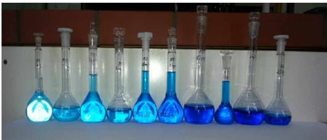
Slika 9. Pripravljene otopine metilenskog plavila različitih koncentracija.
