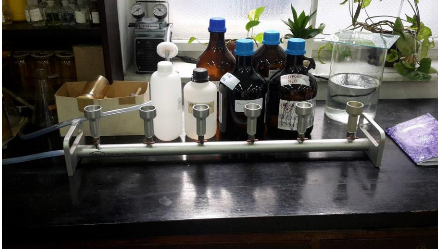
Slika 8. Uređaj za filtraciju PALL Life Sciences
