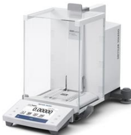
Slika 9. Analitička vaga XS204 DeltaRange, Mettler Toledo 15
