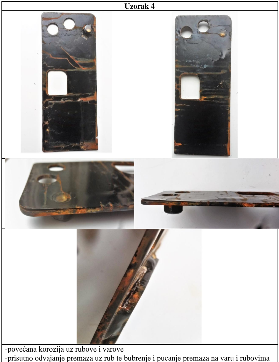
Tablica 9.: Uzorak 4 nakon ispitivanja u slanoj komori
