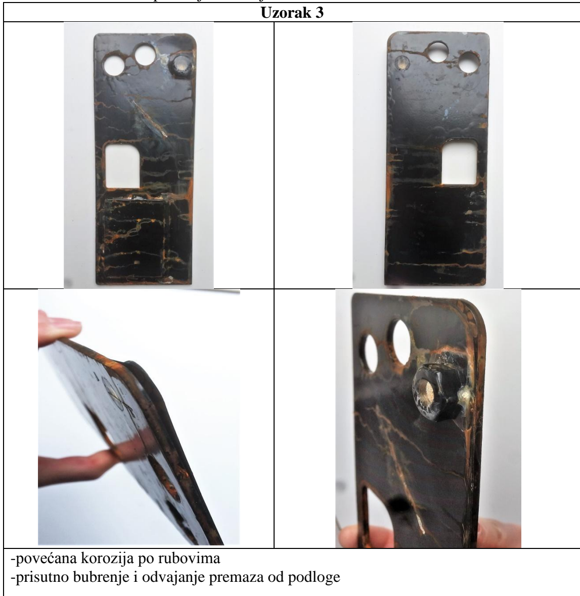
Tablica 7.: Uzorak 3 nakon ispitivanja u slanoj komori
