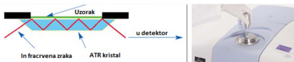
Slika 30. Shematski prikaz principa ATR tehnike 36
