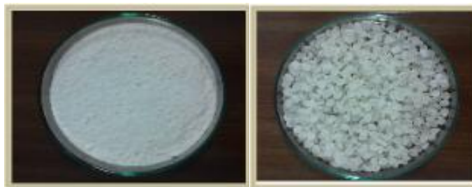
Slika 9. Prirodni pšenični škrob i termoplastični škrob
