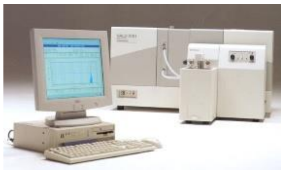
Slika 9. Uređaj za određivanje raspodjele veličina čestica Shimadzu SALD-3101
