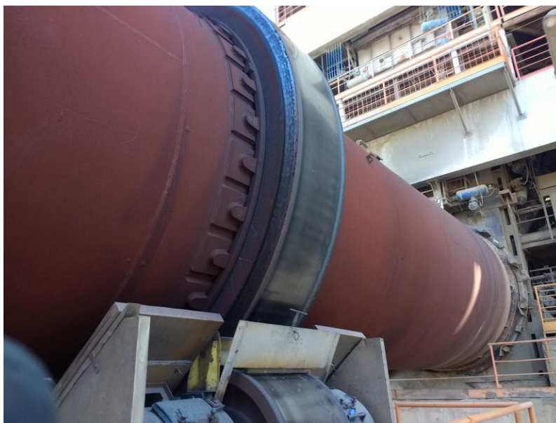
Slika 5 Prsten i valjci peći Izvor: autor
