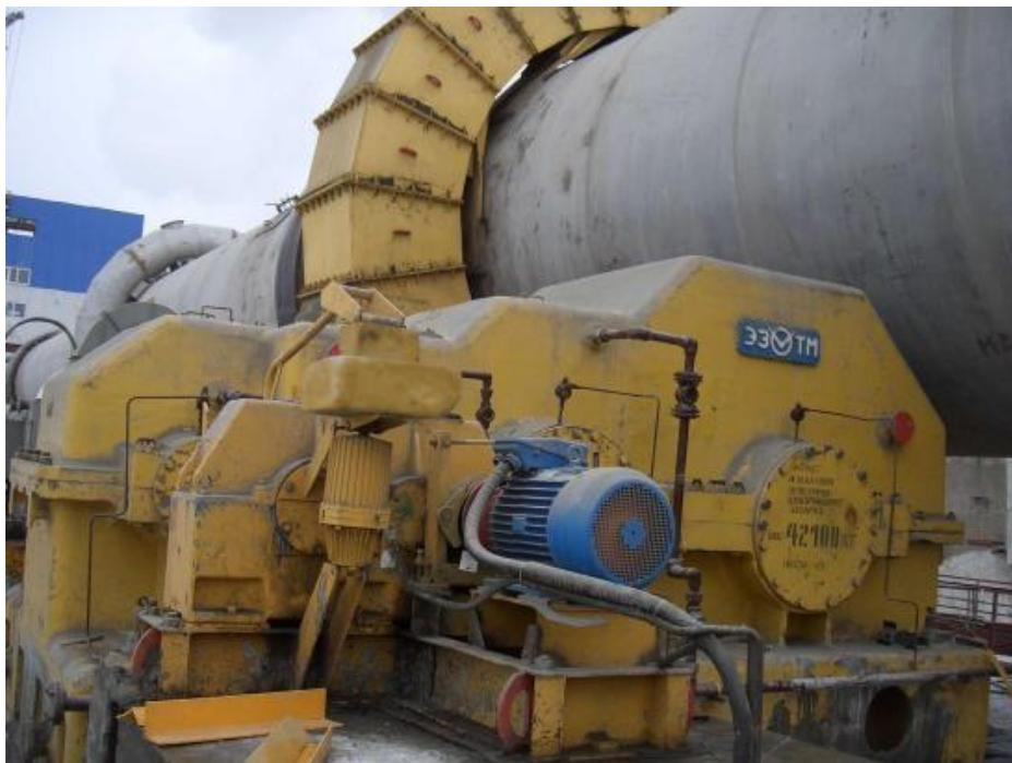
**Slika 6** Pogon rotacijske peći
