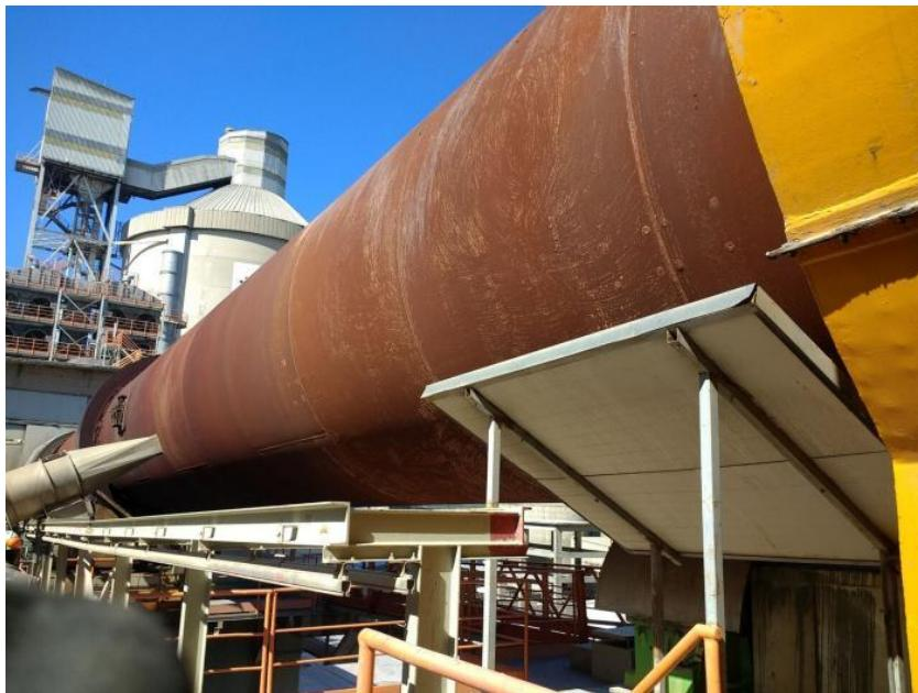
**Slika 3 Rotacijska peć**
