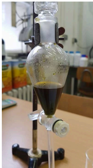
Slika 3.16: Dobiveni biodizel i glicerol procesom transesterifikacije
