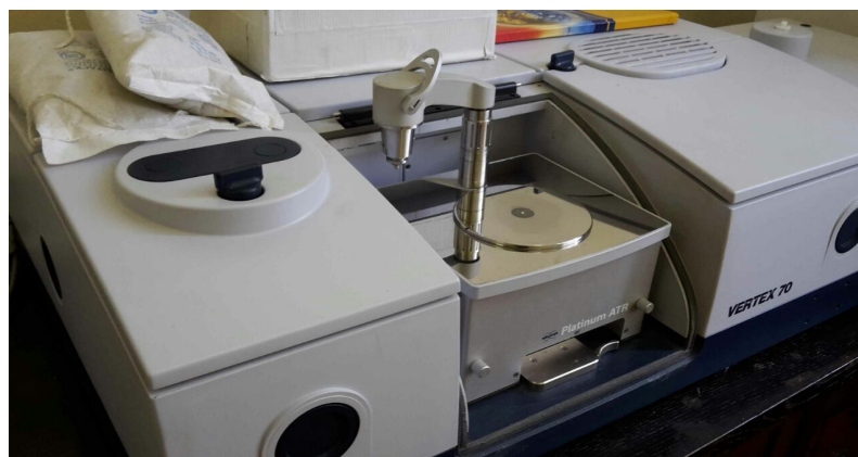
Slika 3.7: Uređaj za FTIR analizu- Bruker Vertex 70
