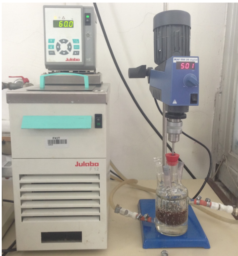
Slika 3.3: Aparatura za kiselu esterifikaciju
