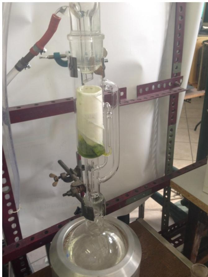
Slika 3.15: Soxhlet aparatura
