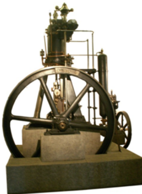
Slika 2.4: Dieselov motor pogonjen na ulje kikirikija
