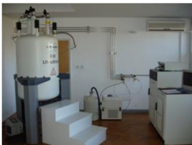
Slika 3.8: ^1\text{H} NMR Spektrometar Bruker Avance 300
