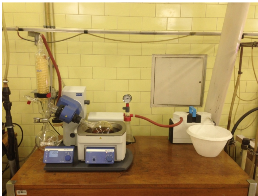
Slika 3.2: Rotacijski isparivač s vakuum pumpom
