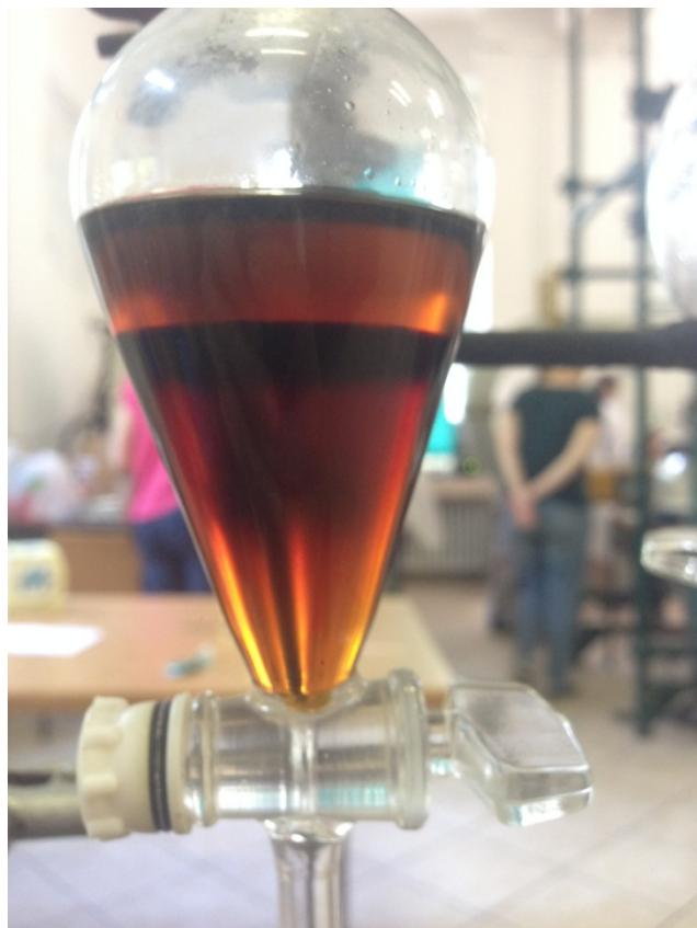
Slika 3.6: Biodizel nakon ekstrakcije, gornji sloj u lijevkumu je biodizel.
