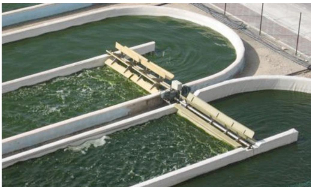
Slika 2.8:Princip otvorenog sustava proizvodnji algi<sup>14</sup>
