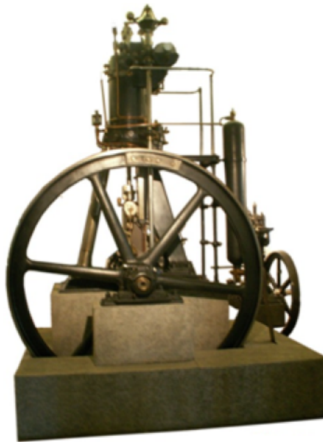
Slika 2.4: Dieselov motor pogonjen na ulje kikirikija
