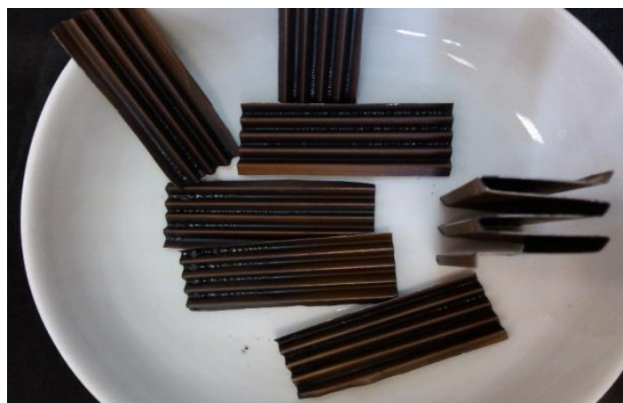
Slika 11. Pripravljene monolitne strukture
