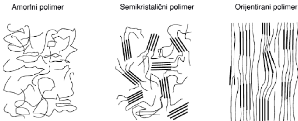
Slika 5. Nadmolekulska struktura polimera.
