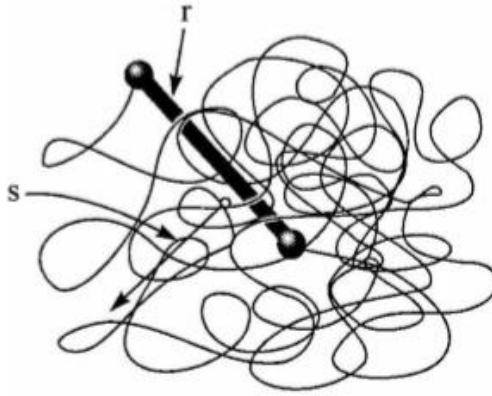
Slika 3. Konformacija statističkog klupka.
