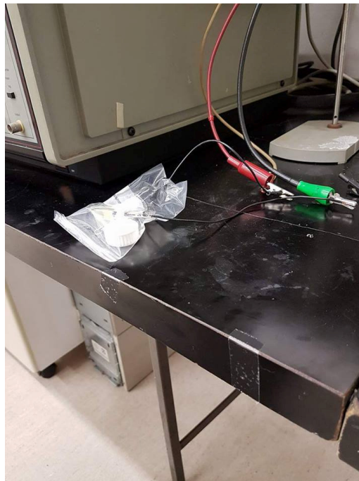
Slika 3.6. Superkondenzator u vrećici sa hermetičkim zatvaračem u kojoj se nalazi i posuda s vodom koja osigurava vlažnu atmosferu i sprječava gubitak elektrolita
