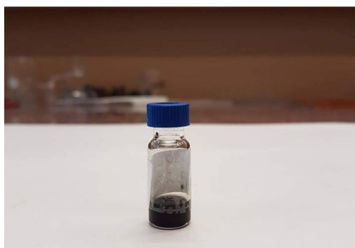
Slika 3.5. Suspenzija usitnjenog rGO3 uzorka koncentracije 10,8 \text{ mg mL}^{-1}
