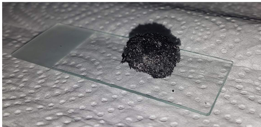
Slika 2.9. Komadić aerogela dobivenog u laboratoriju (osušeni hidrogel)
