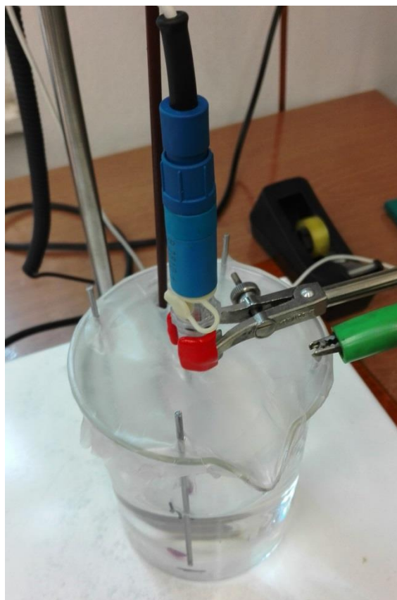
Slika 3-3: Aparatura za mjerenje korozivnog potencijala pri zadanoj temperaturi (lijevo) te prikaz ispitivanog sustava (desno)
