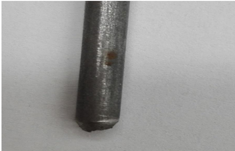
Slika 4-27: Izgled titana nakon 14 dana pri temperaturi od 60°C
