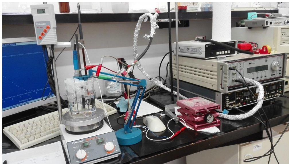
Slika 3-4: Aparatura za EIS mjerenje
