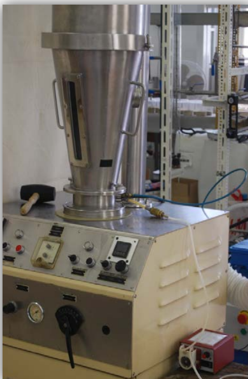
Slika 2.3. Fotografija granulatora s fluidiziranim slojem Uni-Glatt (Glatt GmbH, Binzen, Savezna Republika Njemačka).
