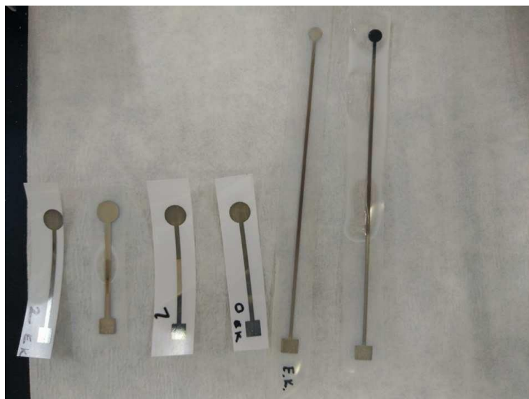
Slika 11. Elektrode modificirane elektrokemijski; sve su pripravljene cikličkom voltametrijom osim zadnje s desna, koja je pripravljena potencijostatski
