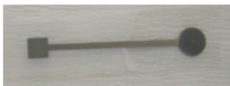
Slika 10. Elektroda modificirana kemijski uz pomoć FeCl 3
