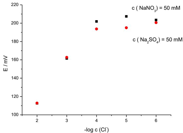
Slika 17. Prikaz odziva mjerenja printane Ag|AgCl elektrode pripremljene pomoću otopine FeCl<sub>3</sub>. Elektroda je 24 sata kondicionirana u zasićenoj vodenoj otopini AgCl-a. Nakon toga je baždarena u otopinama KCl-a koje su pripravljene u 50 mM otopini NaNO<sub>3</sub> i u 50 mM otopini Na<sub>2</sub>SO<sub>4</sub>.
