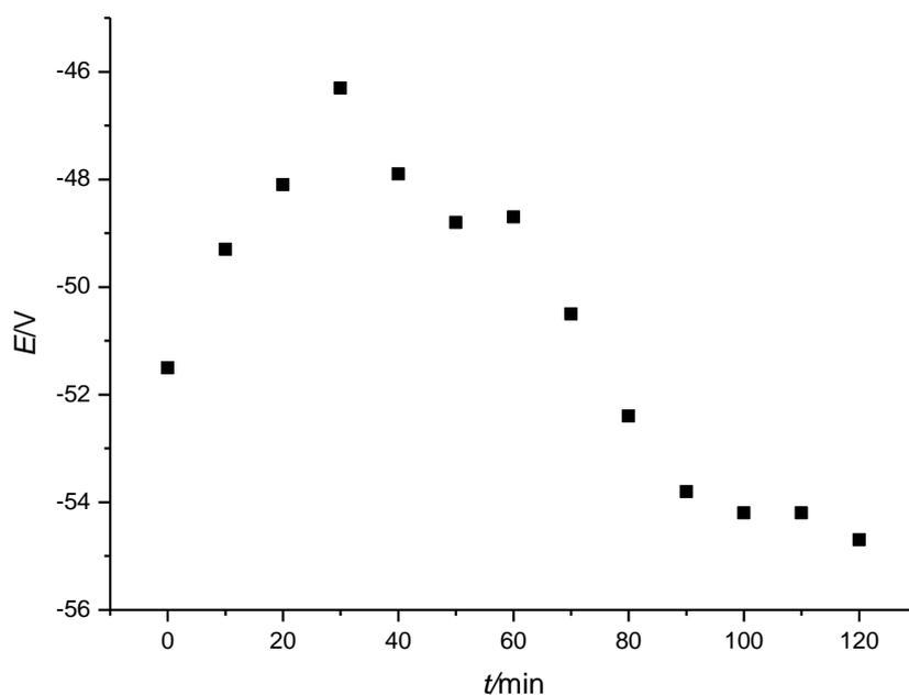
Slika 31. Mjerenje potencijala u ovisnosti o vremenu za Ag|AgCl elektrodu pripremljenu potenciostatkom metodom. Koncentracija otopine KCl = 3 M, referentna elektroda bila je Ag|AgCl|3M KCl||2M NaNO<sub>3</sub>.
