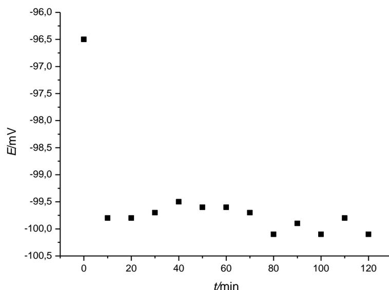
Slika 27. Mjerenje potencijala u ovisnosti o vremenu za Ag|AgCl elektrodu u 3 M otopini KCl-a, referentna elektroda bila je Ag|AgCl|3M KCl||2M NaNO<sub>3</sub>. Elektroda je printana ZOAK tintom.
