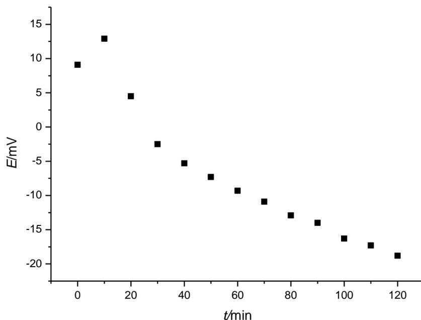
Slika 26. Mjerenje potencijala u ovisnosti o vremenu za Ag|AgCl elektrodu u 1 M otopini KCl-a, referentna elektroda bila je Ag|AgCl|3M KCl||2M NaNO<sub>3</sub>. Elektroda je printana ZOAK tintom.
