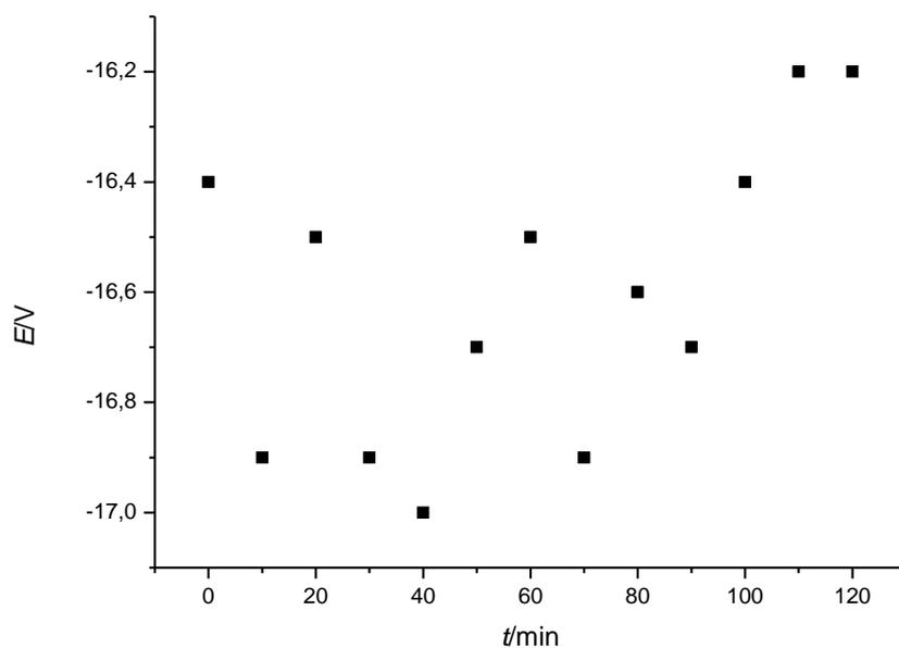
Slika 30. Mjerenje potencijala u ovisnosti o vremenu za Ag|AgCl elektrodu pripremljenu potenciostatski u 1 M otopini KCl-a, referentna elektroda bila je Ag|AgCl|3M KCl||2M NaNO<sub>3</sub>.
