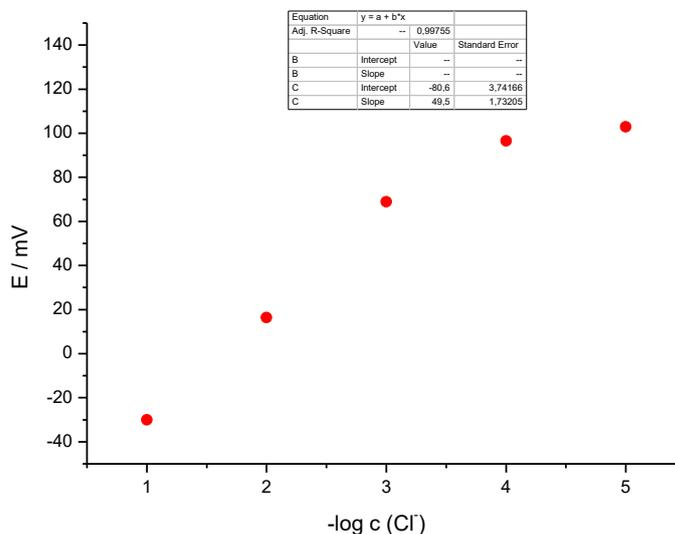
Slika 15. Prikaz odziva printane Ag|AgCl elektrode pripravljene pomoću otopine FeCl<sub>3</sub>.
