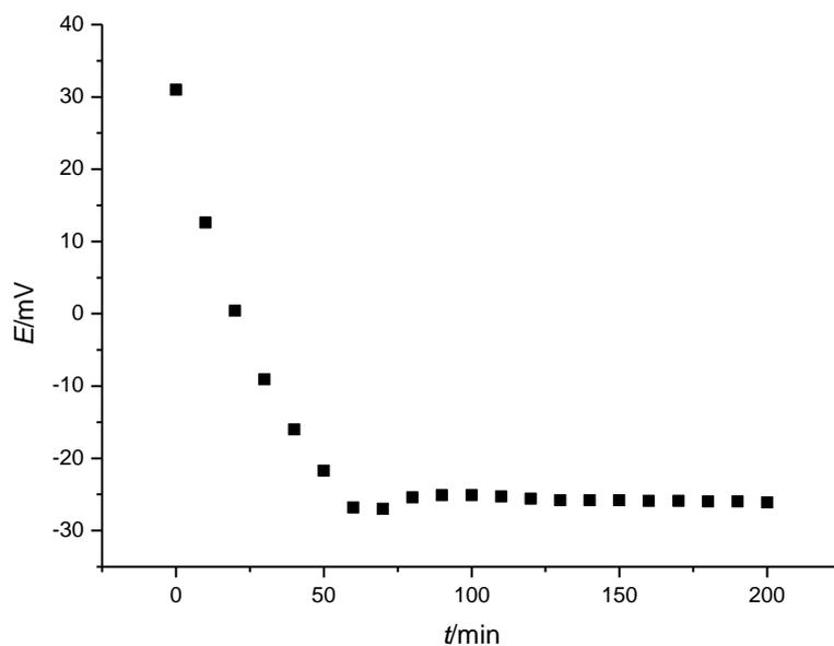
Slika 20. Mjerenje potencijala u ovisnosti o vremenu za Ag|AgCl elektrodu u 1 M otopini KCl-a, referentna elektroda Ag|AgCl|3M KCl||2M NaNO<sub>3</sub>. Elektroda je močena 12 sati prije mjerenja.
