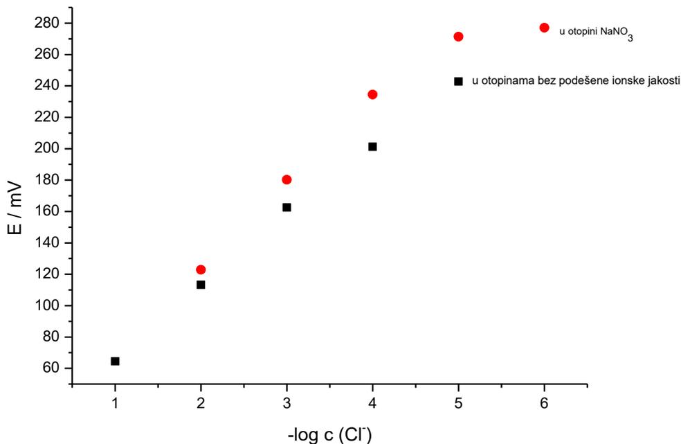
Slika 13. Prikaz odziva klasične Ag|AgCl ionsko-selektivne elektrode pri mjerenju u otopinama klorida sa i bez podešene ionske jakosti. Kao otopina za podešavanje ionske jakosti korištena je 50 mM otopina  $\text{NaNO}_3$ .
