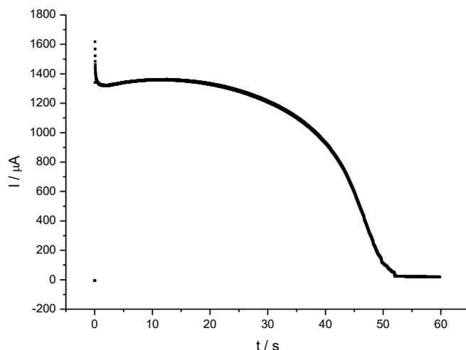
Slika 28. Potenciostatska priprema Ag|AgCl referentne elektrode. Kao radna elektroda korištena je Ag printana elektroda promjera 5 mm. Kao protuelektroda koristila se Pt žica a referentna elektroda bila je Ag|AgCl||3M KCl. Radni potencijal bio je 70 mV, a koncentracija otopine KCl 1M.
