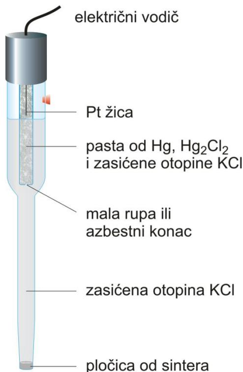
Slika 5. Referentna kalomel elektroda [15]
