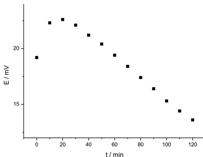
Slika 19. Mjerenje potencijala u ovisnosti o vremenu za Ag|AgCl elektrodu pripremljenu kemijski, u 0,1 M otopini KCl-a, referentna elektroda bila je Ag|AgCl|3M KCl||2M NaNO<sub>3</sub>. Elektroda je močena u otopini 0,1 M KCl pola sata prije mjerenja.
