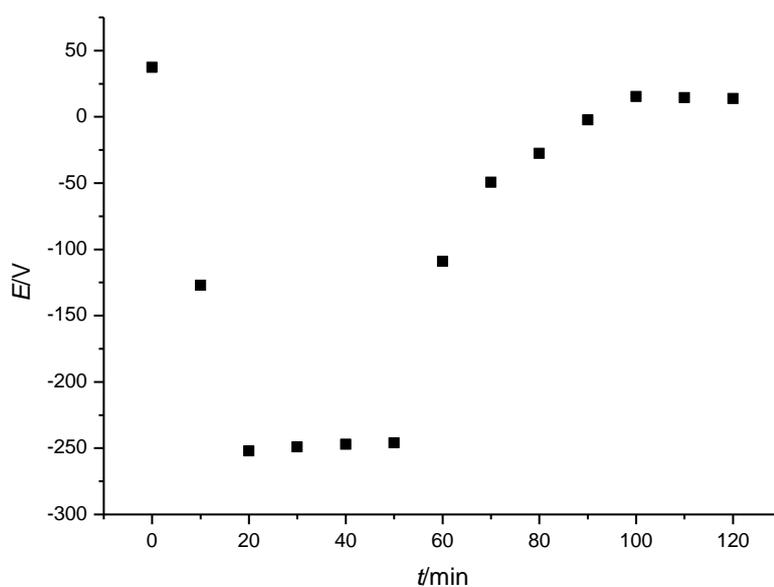
Slika 29. Mjerenje potencijala u ovisnosti o vremenu za Ag|AgCl elektrodu pripravljenu potenciostatski, u 0,1 M otopini KCl-a, referentna elektroda bila je Ag|AgCl|3M KCl||2M NaNO<sub>3</sub>.
