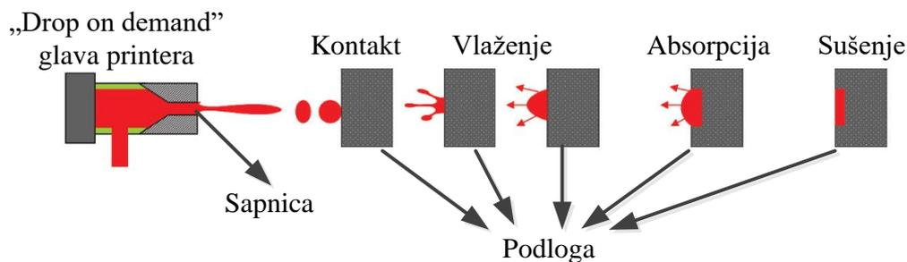
Slika 2. Prikaz rada ink-jet printera koji radi po principu kapljice na zahtjev
