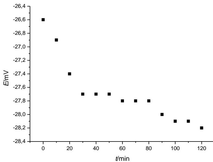
Slika 21. Mjerenje potencijala u ovisnosti o vremenu za Ag|AgCl elektrodu u 3 M otopini KCl-a, referentna elektroda bila je Ag|AgCl|3M KCl||2M NaNO<sub>3</sub>.
