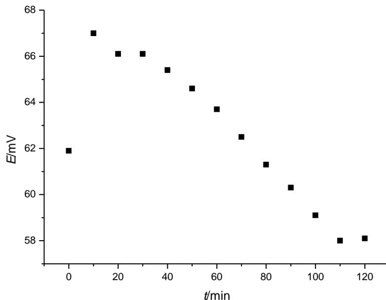
Slika 25. Mjerenje potencijala u ovisnosti o vremenu za Ag|AgCl elektrodu pripremljenu cikličkom voltametrijom, u 0,1 M otopini KCl-a, referentna elektroda bila je Ag|AgCl|3M KCl||2M NaNO<sub>3</sub>. Elektroda je printana ZOAK tintom.
