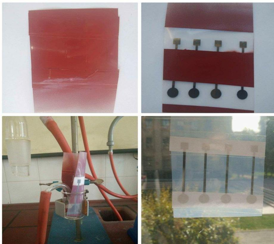
Slika 12. Modifikacija elektrode uz pomoć elementarnog klora
