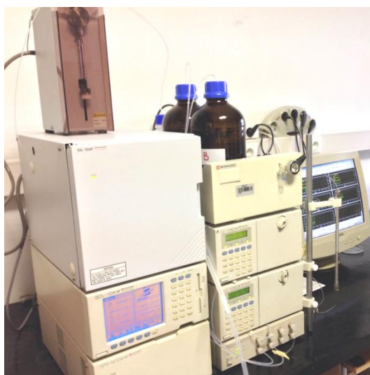
Slika 8. Shimadzu LC-10 tekućinski kromatograf.
