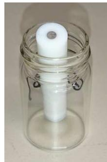
**Slika 3.4.** Radna elektroda
