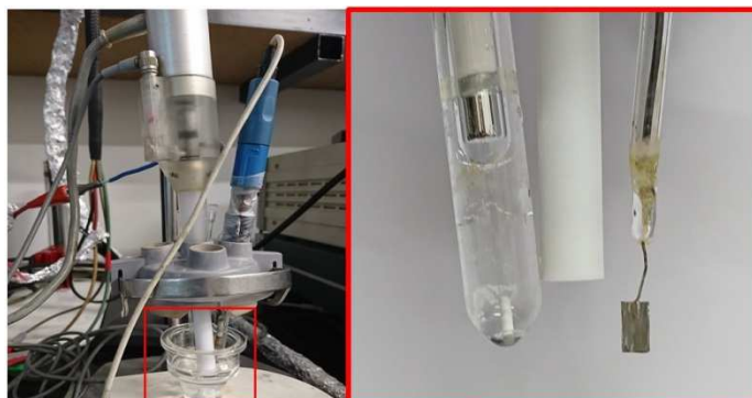
Slika 3.3. Ćelija i troelektrodni sustav za elektrokemijsku sintezu sloja PEDOT i kompozita PEDOT/grafen
