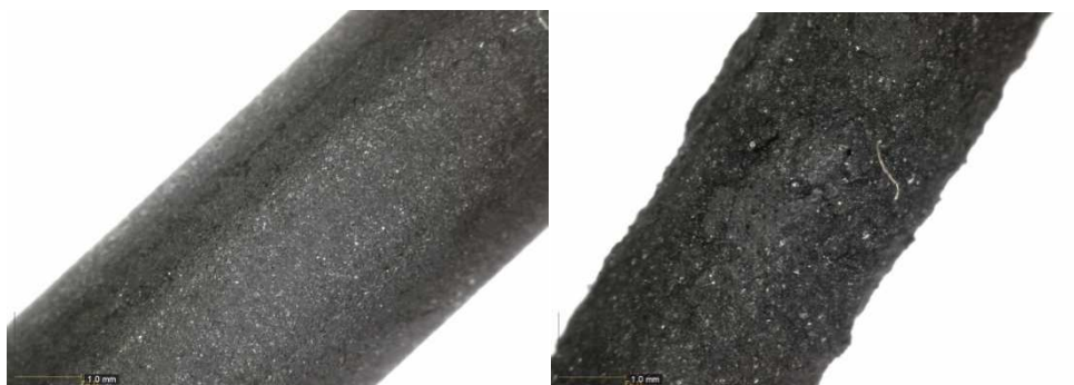
Slika 3.2. Prikaz površine grafitnog štapića prije i nakon raslojavanja
