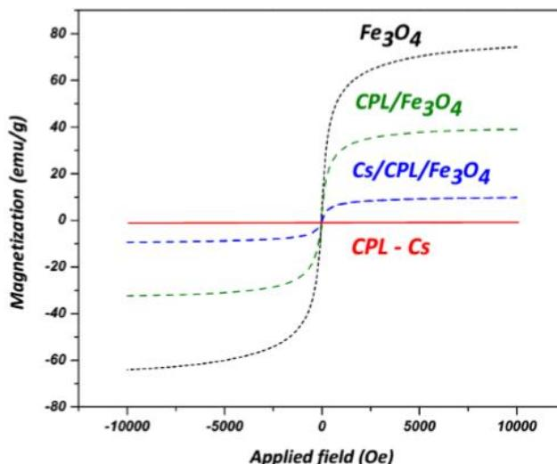
Slika 4.4. Histerezne krivulje za  $\text{Fe}_3\text{O}_4$ ,  $\text{CPL}/\text{Fe}_3\text{O}_4$ ,  $\text{CS}/\text{CPL}/\text{Fe}_3\text{O}_4$  i  $\text{CPL} - \text{CS}$ <sup>[33]</sup>
