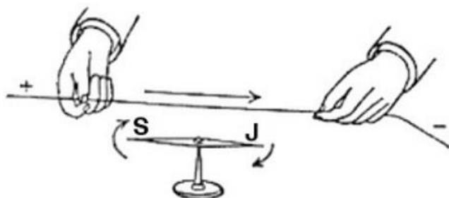
Slika 2.8. Prikaz Oerstedovog pokusa dokazivanja povezanosti električne i magnetske sile<sup>[10]</sup>
