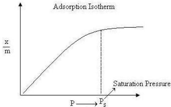
Slika 2.4. Grafički prikaz osnovne adsorpcijske izoterme<sup>[7]</sup>
