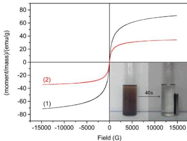
Slika 4.3. Histerezne krivulje  $\text{Fe}_3\text{O}_4$ (1) i  $\text{CCN}/\text{Fe}_3\text{O}_4$ (2)<sup>[2]</sup>
