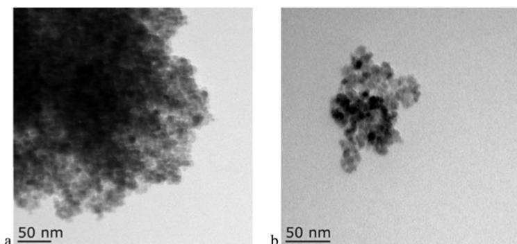
Slika 4.1. TEM slika morfološkog izgleda  $\text{Fe}_3\text{O}_4$ (a) i CCN/ $\text{Fe}_3\text{O}_4$ (b)<sup>[2]</sup>
