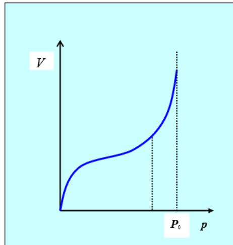
Slika 2.5. Prikaz B.E.T. izoterme,  $p_0$  je tlak zasićenja(tlak isparavanja) pri kojem se postiže maksimalna adsorpcija<sup>[6]</sup>
