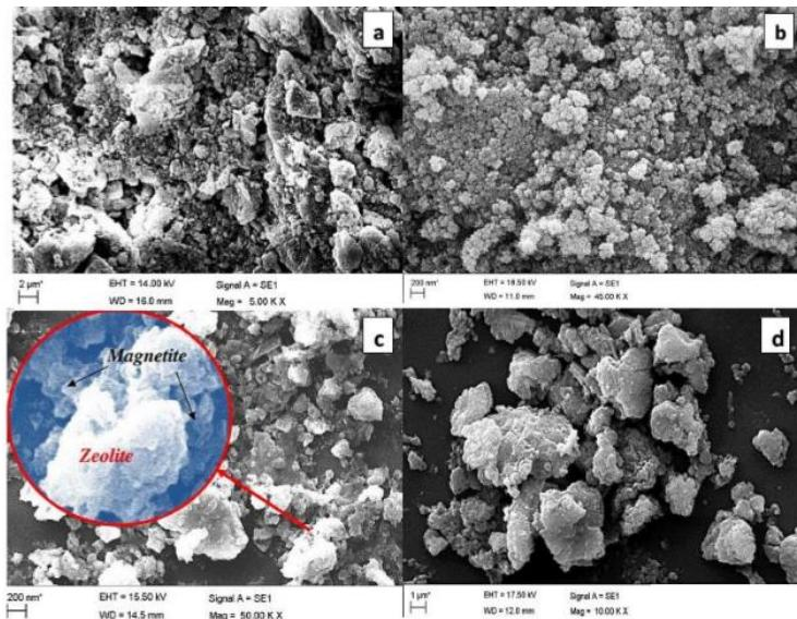
Slika 4.2. SEM slika morfološkog izgleda površine CPL(a),  $\text{Fe}_3\text{O}_4$ (b), CPL/ $\text{Fe}_3\text{O}_4$ -NC(c) i CS/CPL/ $\text{Fe}_3\text{O}_4$ -NC(d) čestica<sup>[33]</sup>
