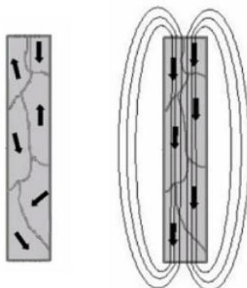
Slika 2.12. Feromagnet bez utjecaja(lijevo) i s utjecajem vanjskog magnetskog polja(desno)<sup>[10]</sup>
