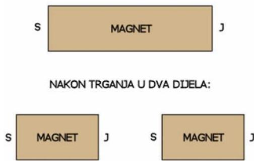
Slika 2.13. Prikaz rastavljanja magneta na manje dijelove i raspored polova<sup>[10]</sup>
