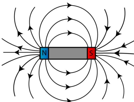
Slika 2.7. Magnetsko polje s magnetskim silnicama<sup>[9]</sup>
