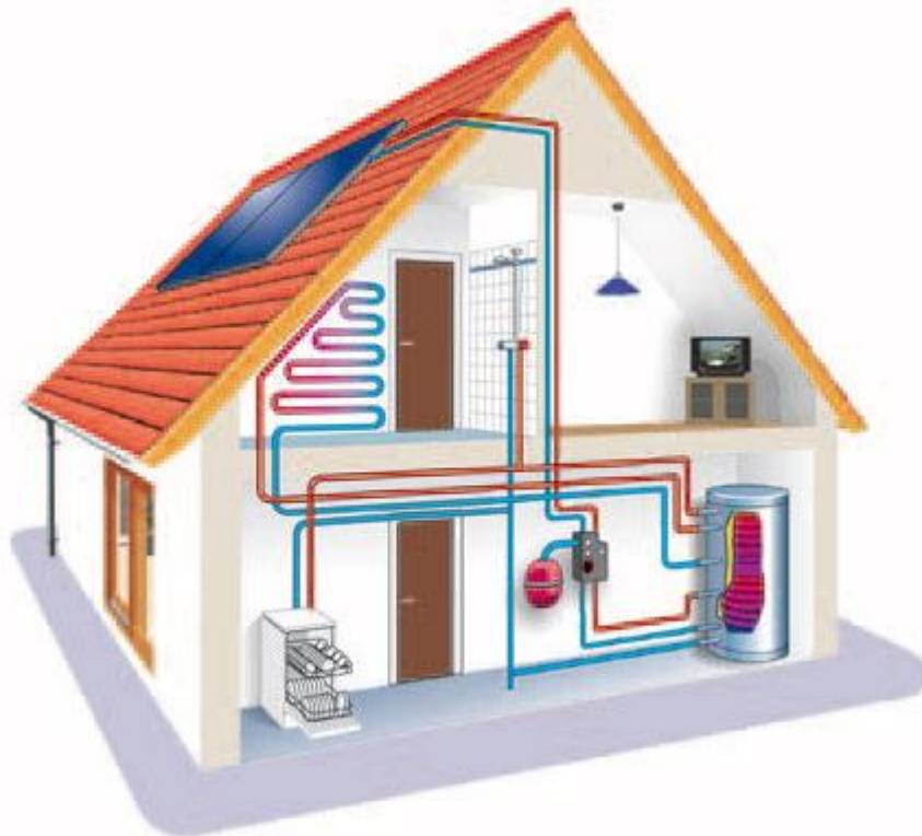
Slika 10 : Solarni sustav od dva kolektora [13]
