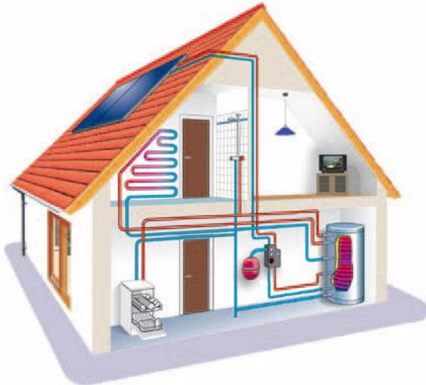
Slika 10 : Solarni sustav od dva kolektora [13]
