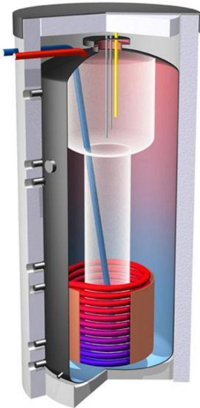
Slika br.15: Kombinirani spremnik za toplu vodu i grijanje prostora [16]
