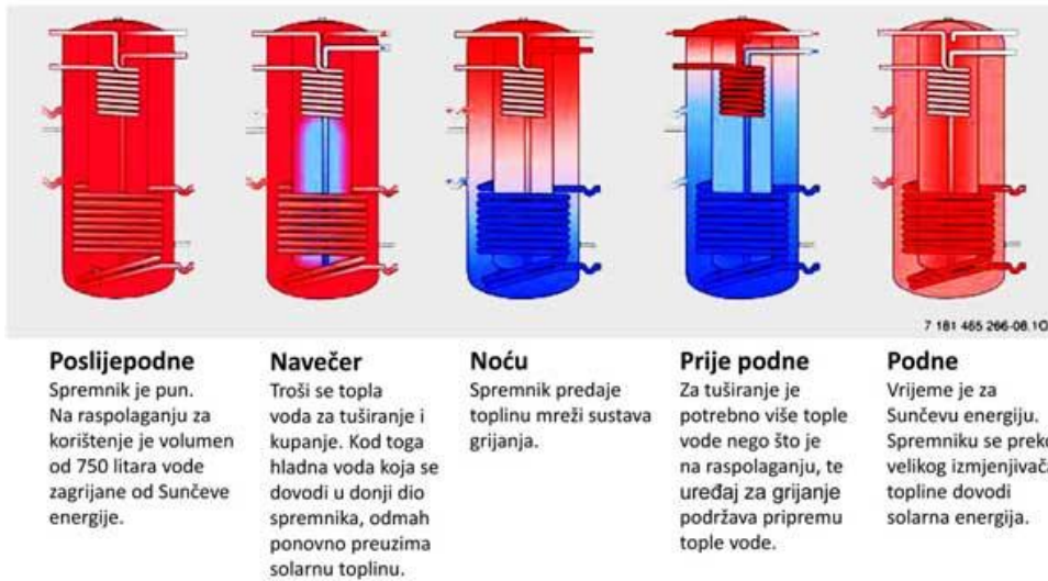
Slika br. 9: Princip rada spremnika topline [12]
