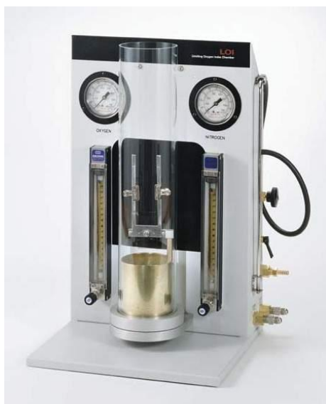
Slika 5. Aparatura za LOI ispitivanja
