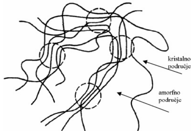
Slika 20. Model kristalastog polimerima prema teoriji resastih micela
