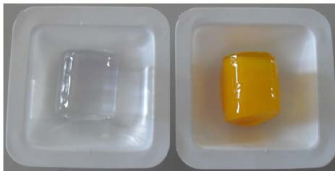
Slika 72. Čisti PAMPS hidrogel (lijevo), PAMPS hidrogel s CdS kvantnim točkama (desno) 28
