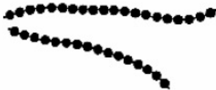
Slika 2. Shematski prikaz linearnih makromolekula 2
