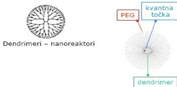
Slika 37. Shematski prikaz dendrimerom enkapsulirane kvantne točke 3
