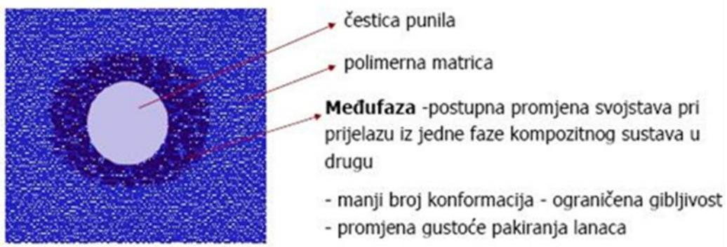
*Slika 20. Trodimenzionalni kontakt između faza sustava*
