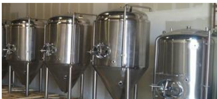
Slika 20. Spremnici za vino i pivo napravljeni od nehrđajućeg čelika [22]
