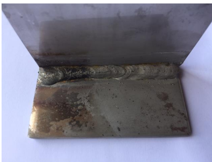
Slika 10. Nehrđajući čelik prije čišćenja otopinom limunske kiseline [6]
