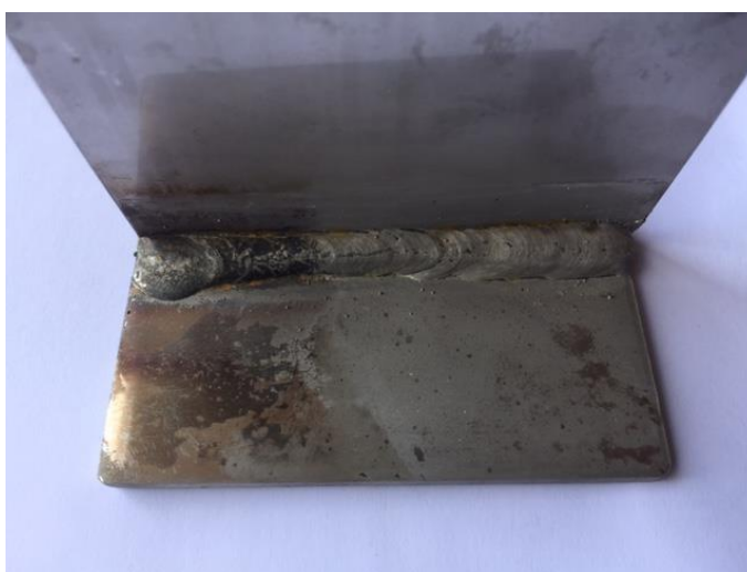
Slika 10. Nehrđajući čelik prije čišćenja otopinom limunske kiseline [6]
