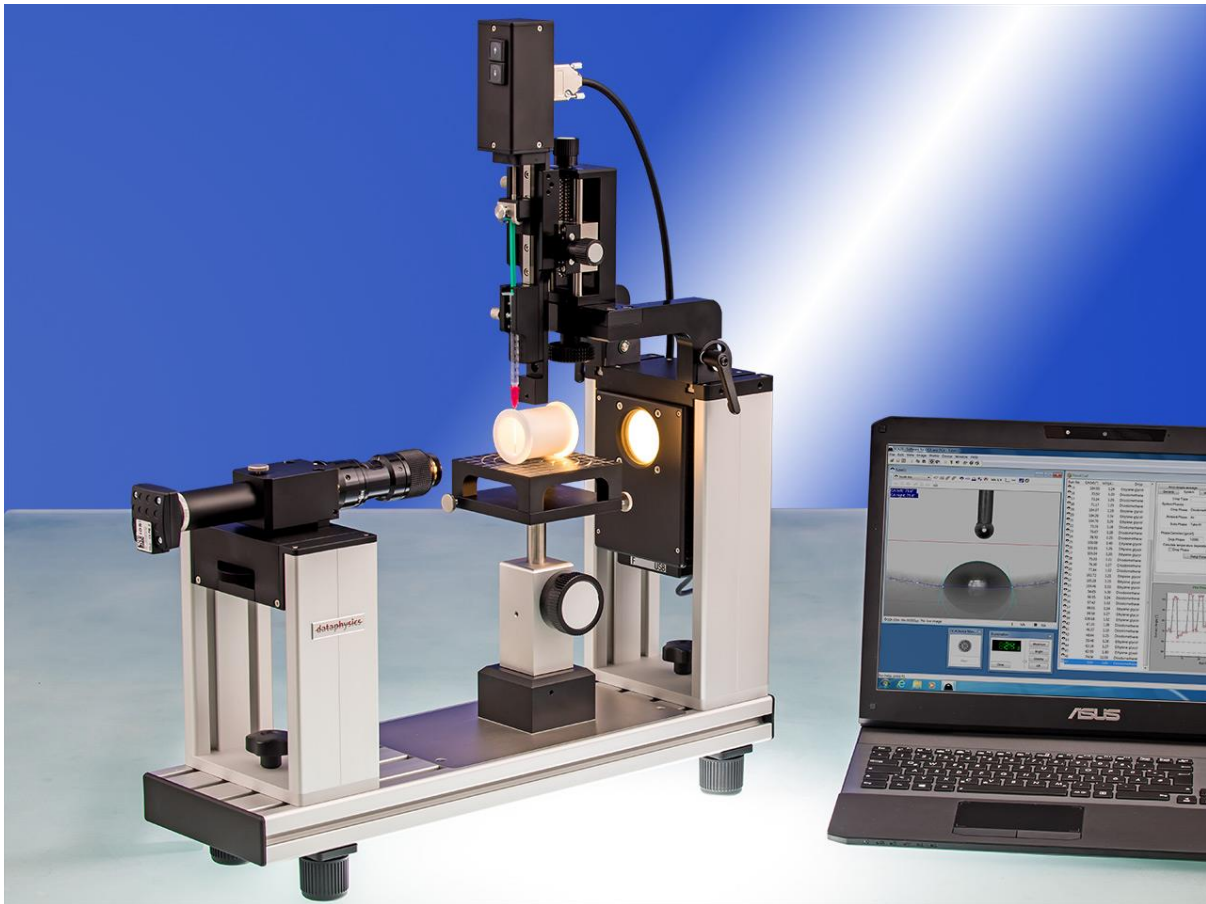
Slika 10. Uređaj za mjerenje kontaktnog kuta (goniometar)
