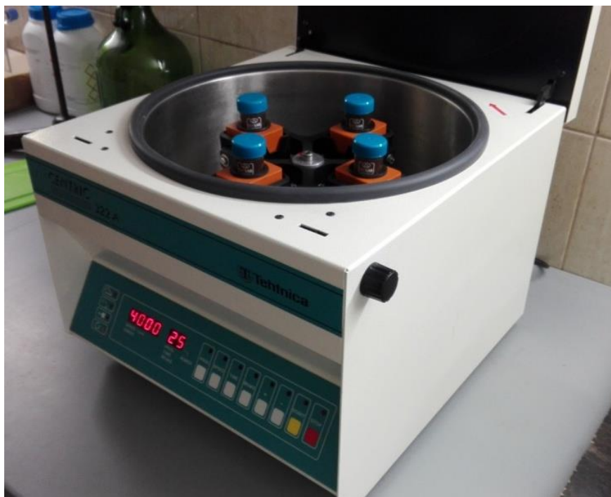
Slika 19. Prikaz centrifuge Technica Centric 322A i kiveta stavljenih unutra
