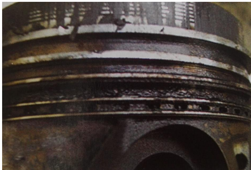
Slika 3. Izgled klipa motora nakon uporabe biljnog ulja 1
