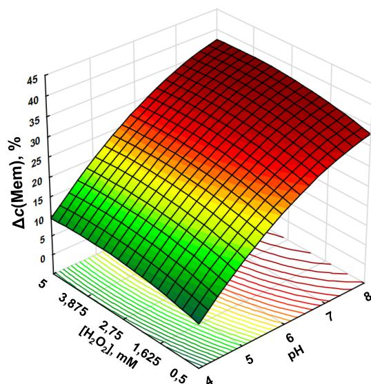
Slika 5. Konverzija memantina u solar/TiO<sub>2</sub> P25/H<sub>2</sub>O<sub>2</sub> procesu.
