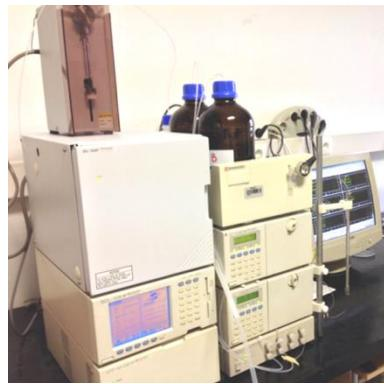
**Slika 2.** Tekućinski kromatograf Shimadzu LC-10.
