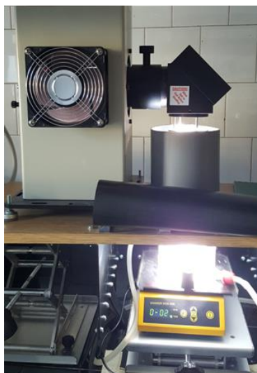
Slika 3. Tresilica s fotokatalitičkim reaktorom ispod Oriel Newport solar simulatora.
