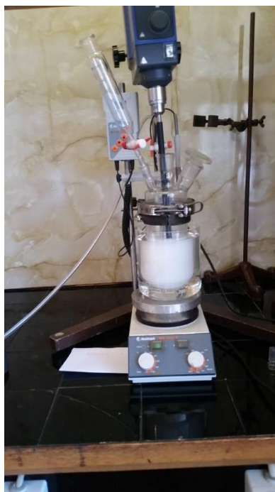
Slika 3.1 Procesa polimerizacije PEDOT/TiO 2 u reaktoru od 500 mL
