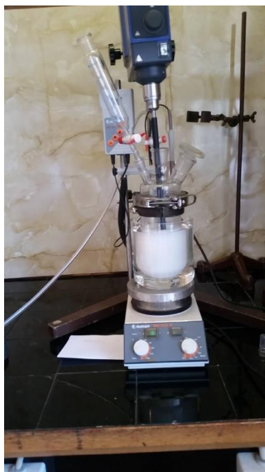
Slika 3.1 Procesa polimerizacije PEDOT/TiO 2 u reaktoru od 500 mL
