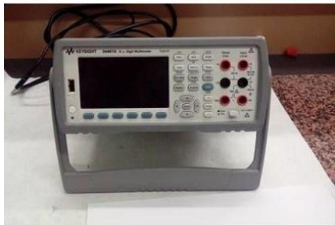
**Slika 3.4.**Uređaj za mjerenje električnog otpora
