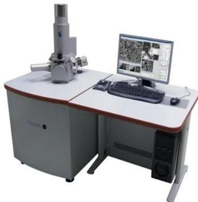
**Slika 3.5** Pretražni elektronski mikroskop *Tescan Vega 3*
