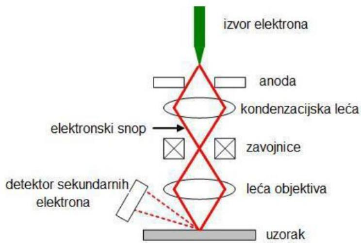
**Slika 2.11.** Dijelovi SEM-a [26]
