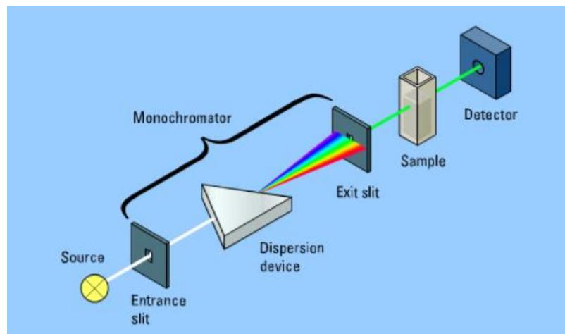
**Slika2.12.** Princip mjerena UV/VIS spektroskopijom[28]
