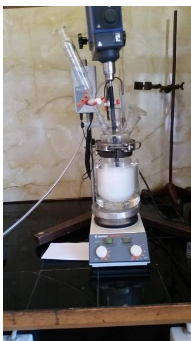
**Slika 3.1** Procesa polimerizacije PEDOT/TiO<sub>2</sub> u reaktoru od 500 mL
