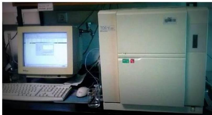
**Slika 3.3**Uređaj za analizu ukupnog organskog ugljika *Shimadzu TOC-V<sub>CPN</sub>*
