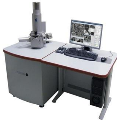
Slika 3.5 Pretražni elektronski mikroskop Tescan Vega 3
