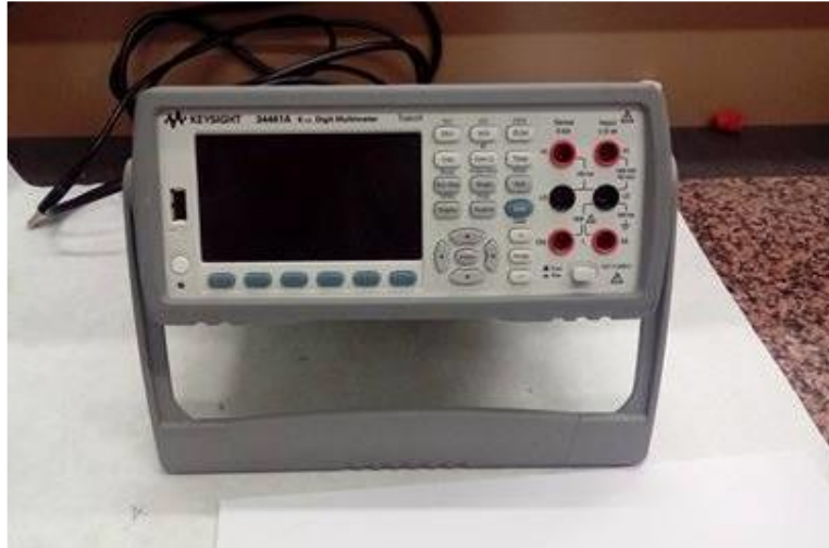
Slika 3.2. Uređaj za mjerenje električnog otpora Keysight 34461 6 1/2 Digit Multimeter
