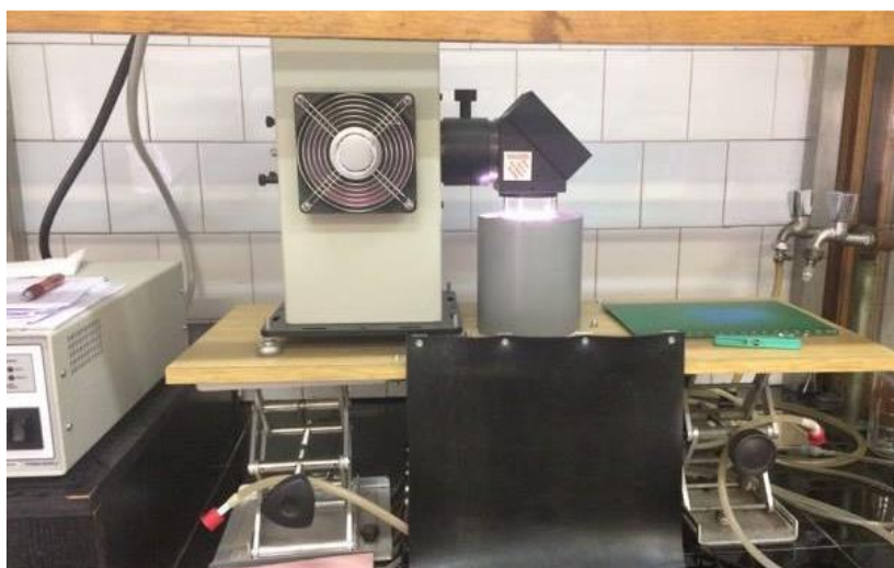
Slika 3.3. Simulator sunčeva zračenja
