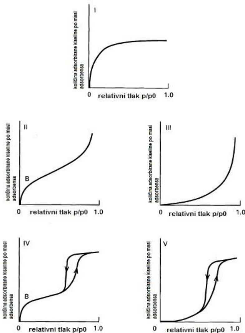
**Slika 2.2.** Osnovni tipovi adsorpcijskih izotermi [4]
