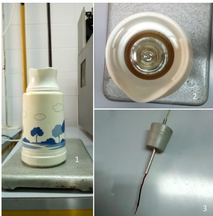
Slika 3.2. Sustav za prikupljanje podataka: 1-termos boca, 2-pogled u unutrašnjost termos boce, 3-temperaturno osjetilo umetnuto u čep termos boce
