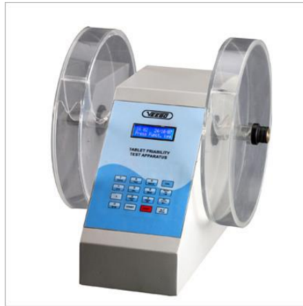
Slika 4. Uređaj za test rastrošljivosti (J. Engelsmann)
