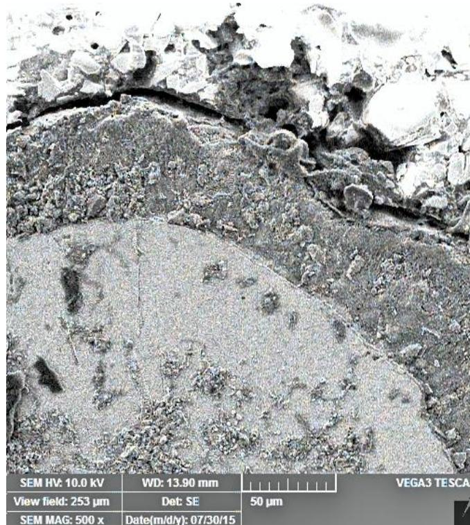
**Slika 4.7.** SEM slika presjeka navoja.
