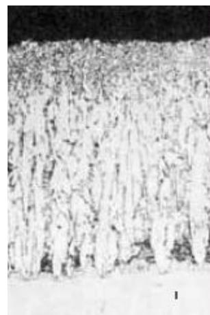
**Slika 2.6.** Razlika u mikrostrukturi između a) prevlake na čeliku sa preporučenim sadržajem Si i b) prevlake na čeliku sa povećanim sadržajem Si<sup>8</sup>.
