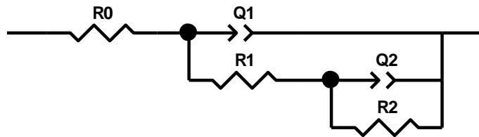
**Slika 3.6.** Ekvivalentni krug za modeliranja podataka EIS metode.
