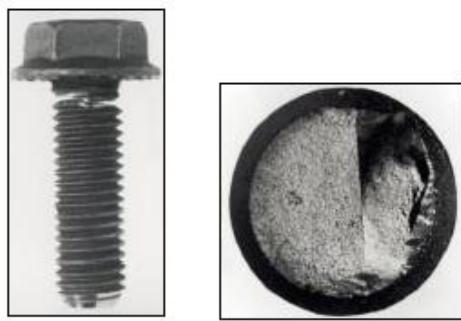
**Slika 2.12.** Oštećenje vijka uslijed djelovanja vodikove krhkosti<sup>12</sup>.
