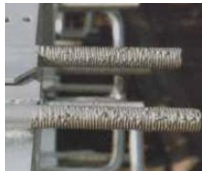
**Slika 2.8.** Defekti na poinčanim površinama<sup>8</sup>.
