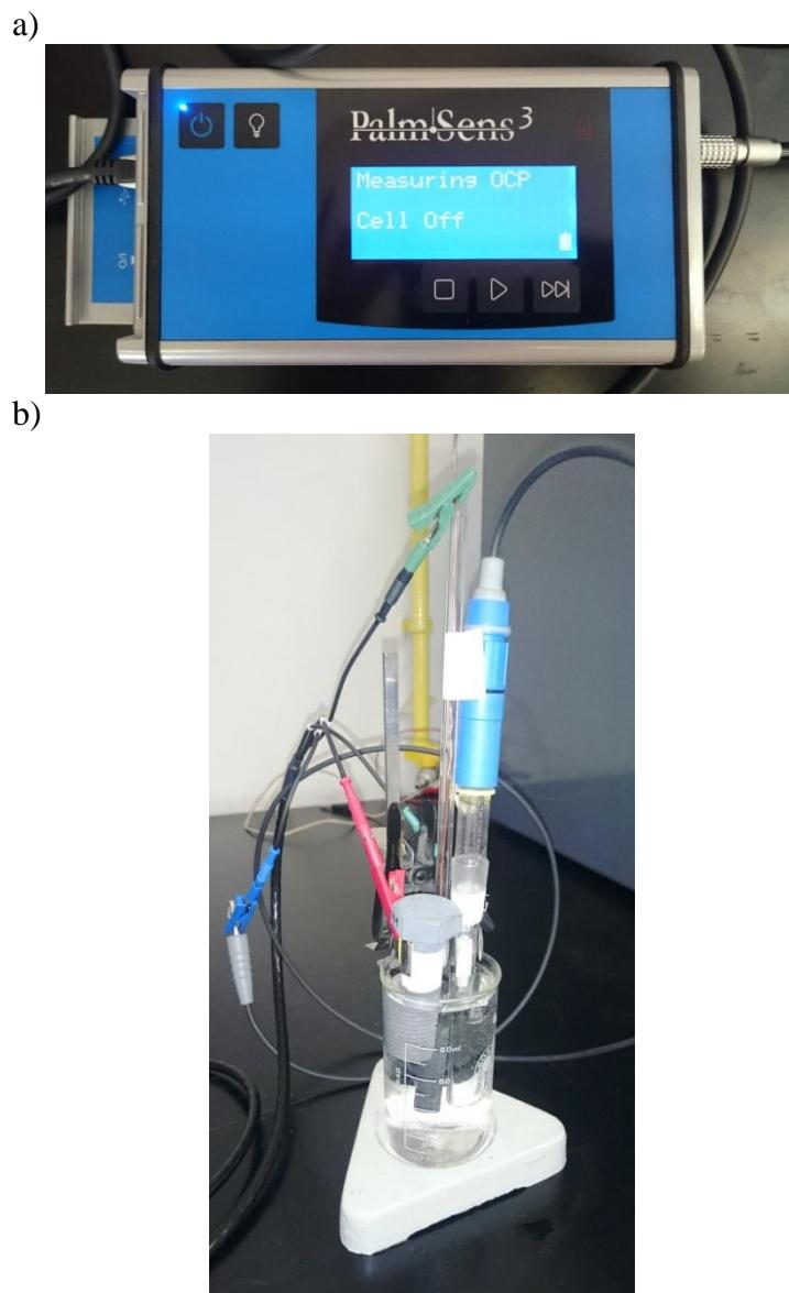
Slika 3.5. a) potenciostat i b) ćelija za mjerjenje.
