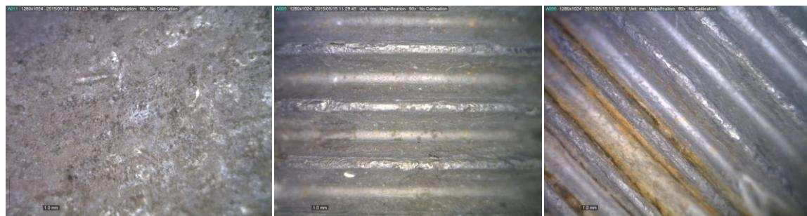
**Slika 4.1.** Nekorišteni vijci pod mikroskopskim povećanjem 60×.
