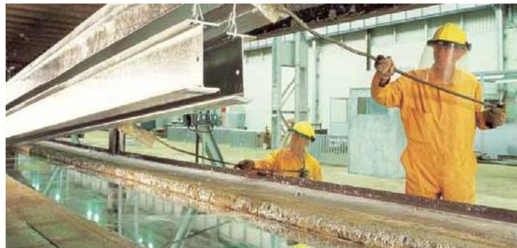
**Slika 2.2.** Postupak fluksiranja<sup>5</sup>.
