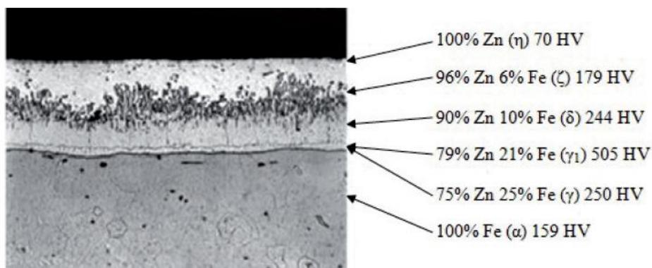
**Slika 2.9.** Pravilna mikrostruktura vrućeg poinčanja<sup>10</sup>.
