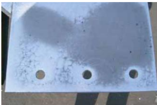
Slika 2.7. Razlika u izgledu prevlake nastala uslijed razlike u brzini hlađenja 8 .
