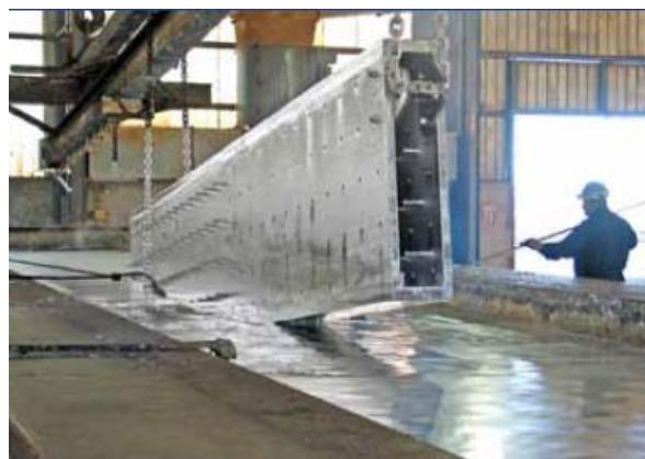
**Slika 2.3.** Povlačenje predmeta iz kade sa rastaljenim cinkom<sup>3</sup>.
