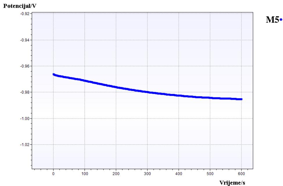
**Slika 4.14.** Vremenska ovisnost potencijala otvorenog kruga elektrolitički poinčanog vijka.
