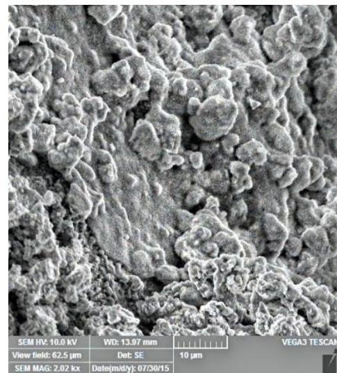
**Slika 4.6.** SEM slika praha između navoja vijka pri povećanju od a)  $40\times$  i b)  $2000\times$ .
