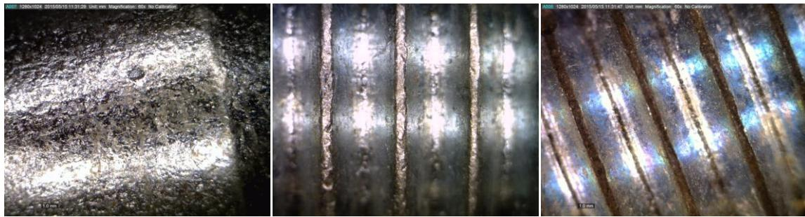
**Slika 4.4.** Elektrolitički pocinčani vijci pod mikroskopskim povećanjem 60×.
