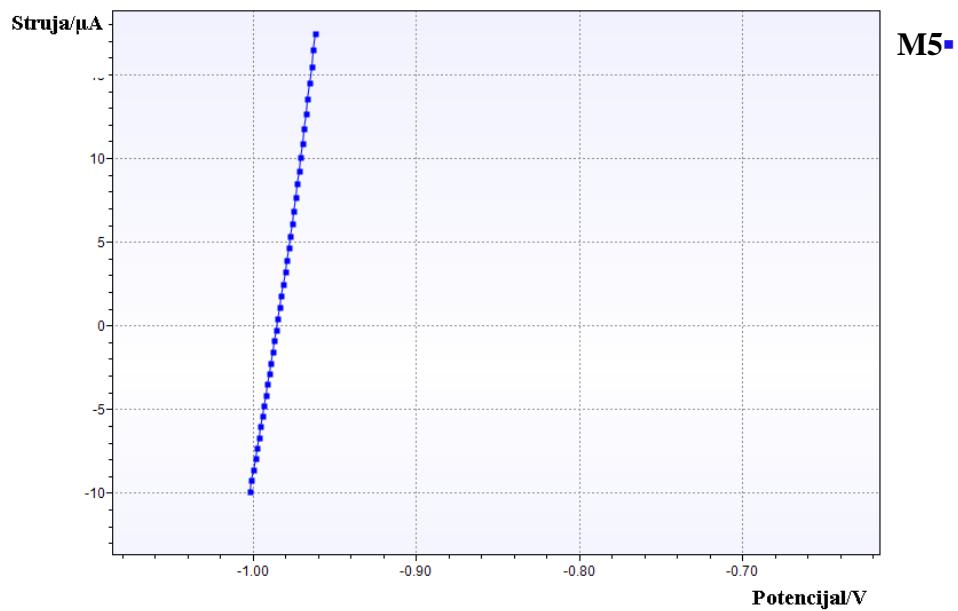
**Slika 4.18.** Pravac linearne polarizacije elektrolitički poinčanog vijka.
