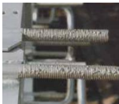
Slika 2.8. Defekti na pocinčanim površinama 8 .
