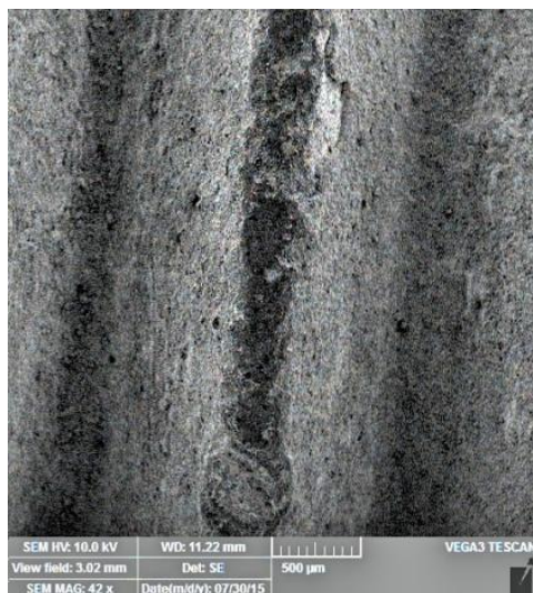
Slika 4.5. SEM slika navoja vijka pri povećanju od a) 40× i b) 2000×.
