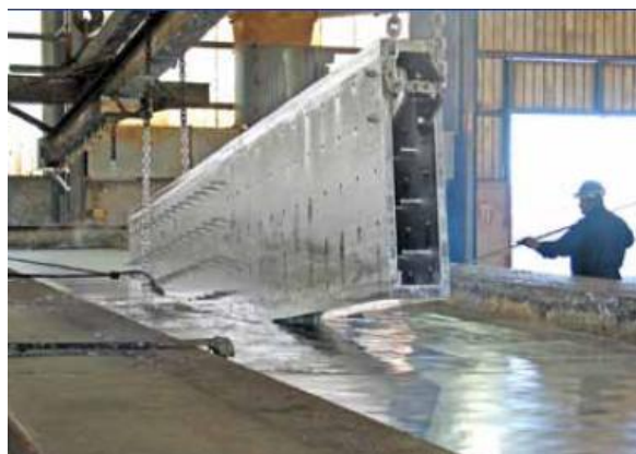
Slika 2.3. Povlačenje predmeta iz kade sa rastaljenim cinkom 3 .
