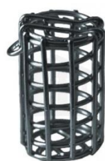
Slika 8. Košarica za potapanje tablete
