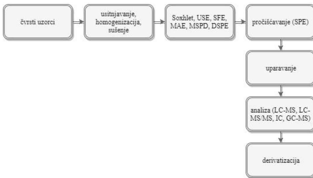
Slika 2. Načini pripreve čvrstog uzorka [31]
