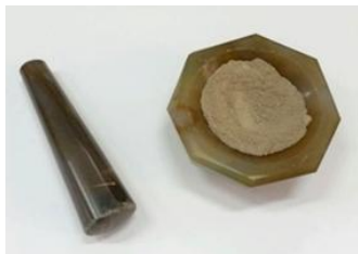
Slika 9. Usitnjavanje špikanog sedimenta u tarioniku
