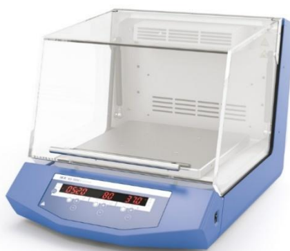
Slika 10. Mućkalica IKA, KS 3000i control, Njemačka [67]
