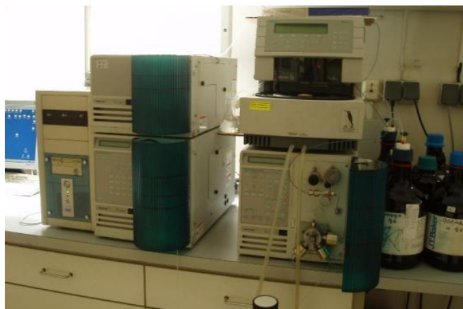
Slika 14. Tekućinski kromatograf visoke djelotvornosti, Varian ProStar 500, SAD
