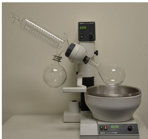
Slika 13. Rotavapor BÜCHI R-114, Švicarska i vodena kupelj BÜCHI Waterbath B-480, Švicarska [70]
