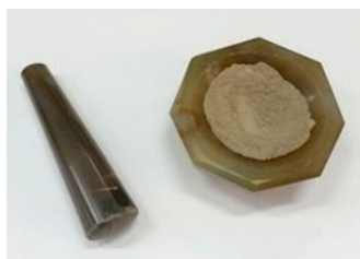
Slika 9. Usitnjavanje špikanog sedimenta u tarioniku
