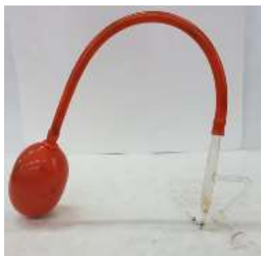
Slika 12. Prskalica kojom je provedena vizualizacija metalnih kationa
