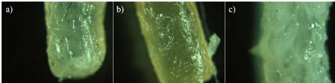
Slika 17. Mikrografija filamenata, uvećanje 64x a) F2500 b) F710 c) filament otopljen u vodi
