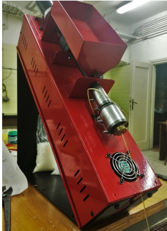
Slika 12. Ekstruder korišten u radu
